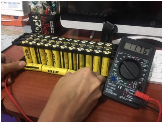
Imagen 3. Bloque de 13 celdas, 3 en serie. Fuente: Autores.
