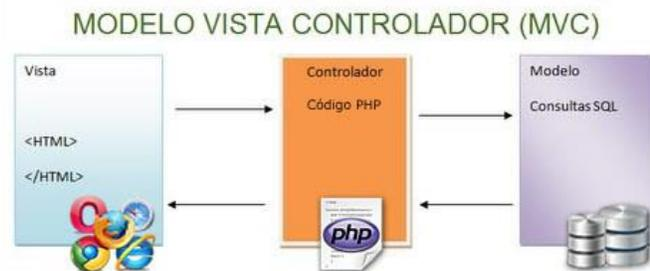
**Figura No. 3.** Ejemplo de arquitectura modelo vista controlador (MVC).
