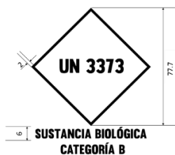
Figura 3. Etiqueta para embalaje terciario. Medidas en mm.
